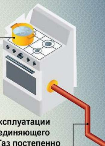
От долгой или неправильной эксплуатации происходит разрыв шланга, соединяющего газовую магистраль с плитой. Газ постепенно заполняет помещение. Искра - взрыв
