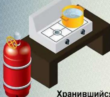
Хранившийся долгое время баллон с газом заносят в теплое помещение. Газ расширяется и разрывает баллон
